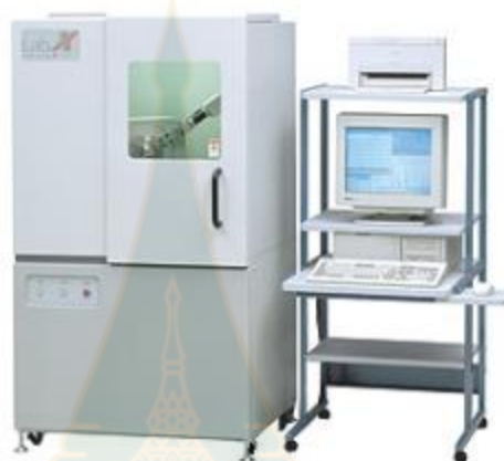
ภาพที่ 2.4 เครื่องวิเคราะห์การเลี้ยวเบนรังสีเอกซ์หรือ X-ray Diffractometer (XRD)
